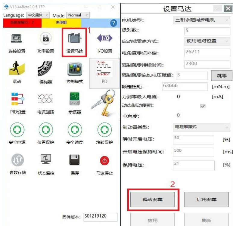
图 8-2 连接上位机释放刹车
