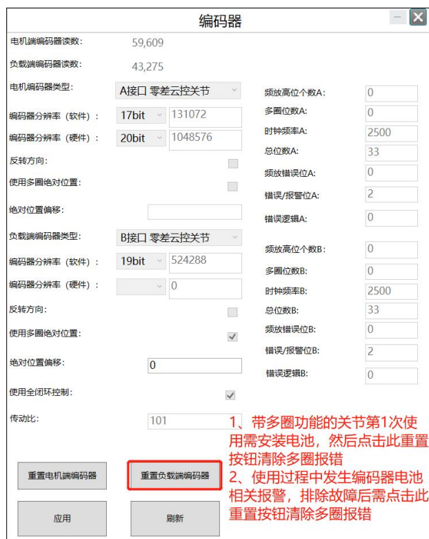
图 10-3 负载端编码器复位操作
