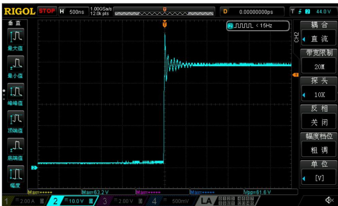
图 4-2 关节异常供电的输入电压波形（Max=63.2V&gt;60V）
