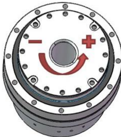
图 5-1 关节正转方向
