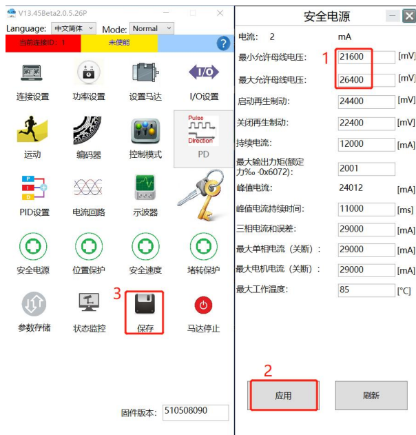
图 4-3 使用 DC24V 供电电源设定举例
